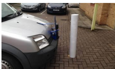
Palo di 1 m di lunghezza di fronte a una telecamera installato a 0,6 m
